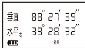
2) 使用水平以及垂直制微动螺旋精确照准待测目标即可读出当前目标的垂直角度值 ( $\theta$ )
