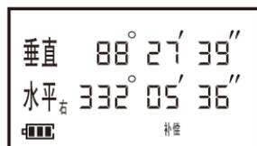
2) 按[角度/斜度]键，仪器垂直角显示角度切换为坡度模式，角度值为： $2.686\%$ 。
