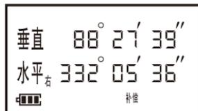
2) 按[锁定]键,仪器下方显示“锁定”字样,表明仪器水平角度值处于锁定状态,此时转动仪器水平角度值不变,且其余所有会对仪器角度值产生影响的按键失效;
