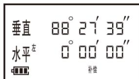
3) 参考7.1水平角度测量(顺时针)中步骤2至5, 读出两点间的水平夹角的值。
