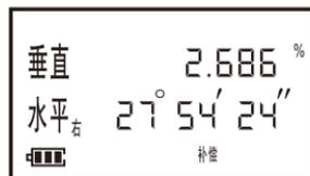
注：坡度值的范围为 $-100\% \sim 100\%$ ，对应的天顶距的范围为“ $45^\circ \sim 135^\circ$ ”以及“ $225^\circ \sim 315^\circ$ ”，超出范围后，仪器显示ERROR报错。
