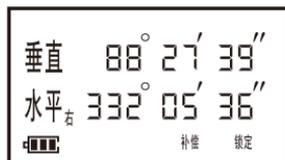
3) 再次按[锁定]键,则仪器下方“锁定”字样隐去,表明仪器水平角恢复为正常状态。
