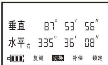
DT20系列电子经纬仪液晶显示屏共现实三行内容;第一行为垂直度盘角度值;第二行为水平度盘角度值;第三行为电池容量和仪器状态。
