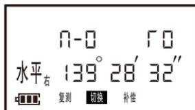
3) 使用水平以及垂直制微动螺旋使仪器精确照准第一个目标A;
