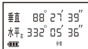
2) 通过水平和垂直制微动螺旋使得仪器精确的照准第一个目标A;
