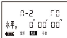
5) 使用水平以及垂直制微动螺旋使仪器精确照准第二个目标B;
