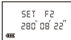
4) 旋转仪器, 在倒镜位置重新照准上一步骤中的目标, 按 [左 = 右] 键, 屏幕显示“SET”;
