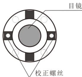
**注意:** 首先松开十字丝竖丝需要移动方向一端的校正螺丝, 然后等量旋紧另一端的校正螺丝, 逆时针方向旋转松, 顺时针方向旋转紧, 旋转量尽量相同。
